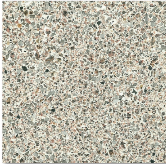
Abb. 5 (Bild links) Rosa Granit und der Halbedelstein Rosenquarz bilden die Basis dieses außergewöhnlichen Betonwerksteines
